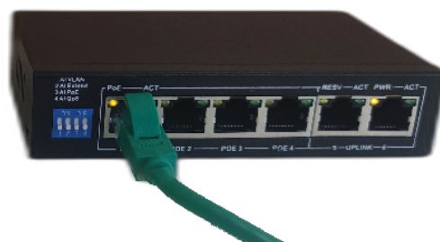
Вариант подключения через PoE-свитч
