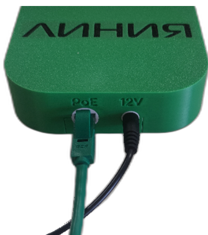
Подключение с помощью блока питания
